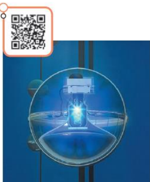
Рис. 104. Фотоумножитель внутри оптической ячейки детекторной системы нейтринного телескопа
