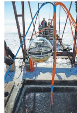
Рис. 105. Спуск новой оптической ячейки на дно озера Байкал
