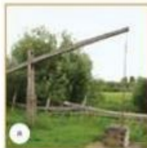
48.6. Примеры использования простых механизмов: колодец-журавль (а), колодец с воротом (б)
